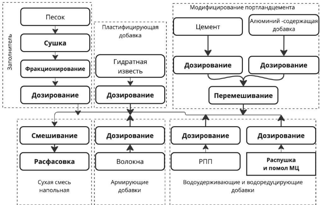
Рисунок 5.1 Технологическая схема производства ССН
